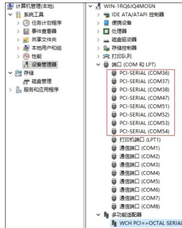
此时，串口号未按顺序查找，需要进一步对串口号进行排序。打开驱动文件夹Driver，点击Windows，点击PUMPSETUP64将出现以下界面。随后点击“遇到问题请点击”。
